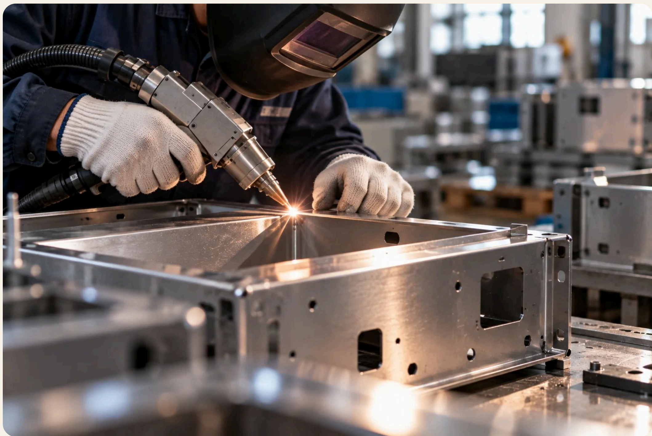
激光焊不锈钢机箱：焊缝 0.2–2 mm，热影响区小于 1 mm
