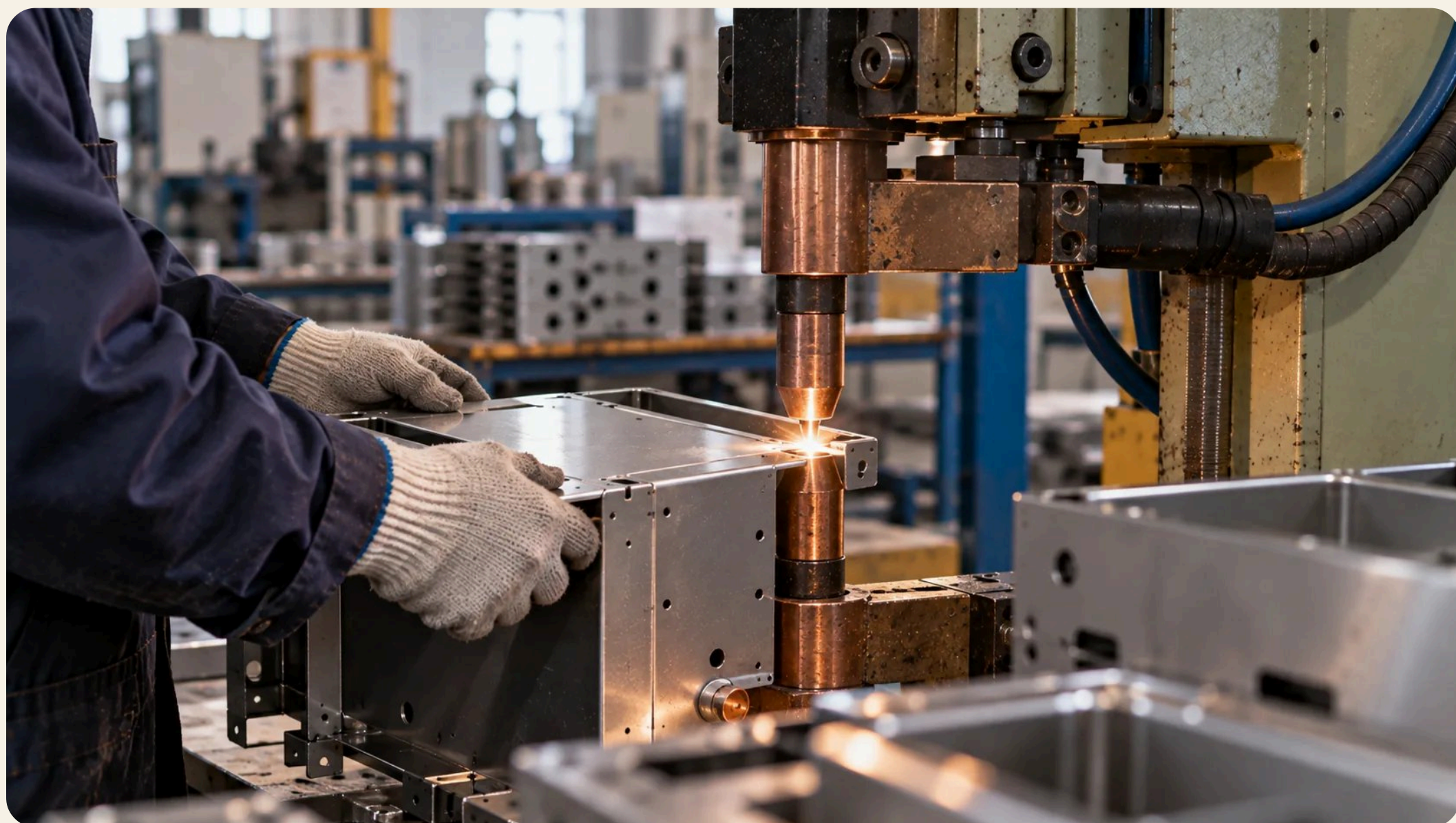
点焊不锈钢支架：焊点一致，不用焊丝
