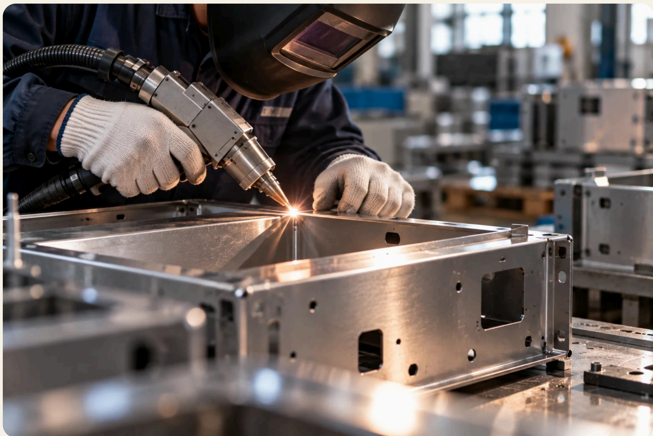
ステンレス筐体のレーザー溶接 — ビード幅 0.2-2mm、熱影響部 1mm 未満
