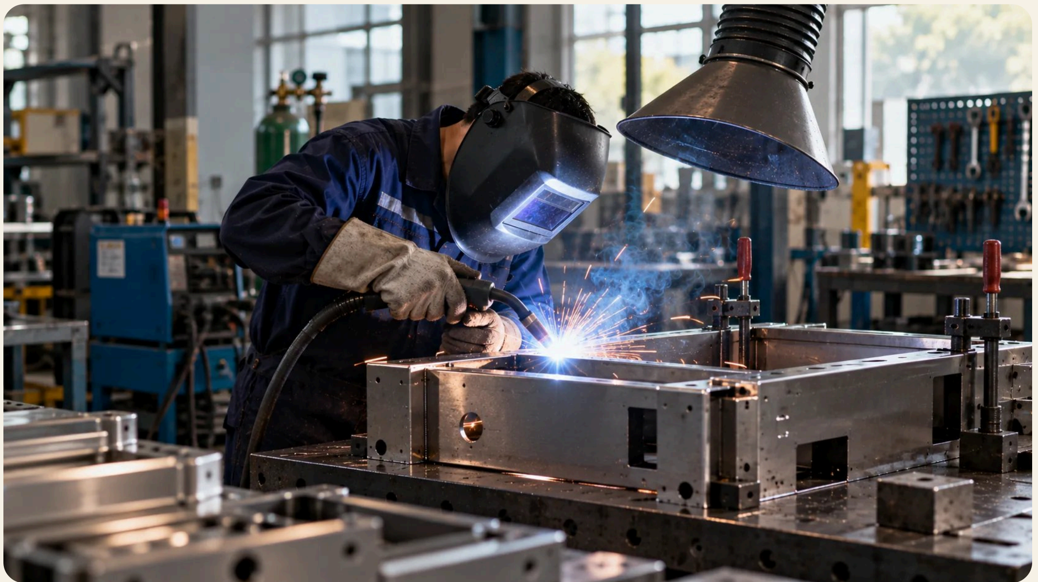
Soldadura MAG: cordón continuo en caja, hasta IP65
